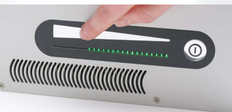
Helligkeitseinstellung über Touch-Slider
